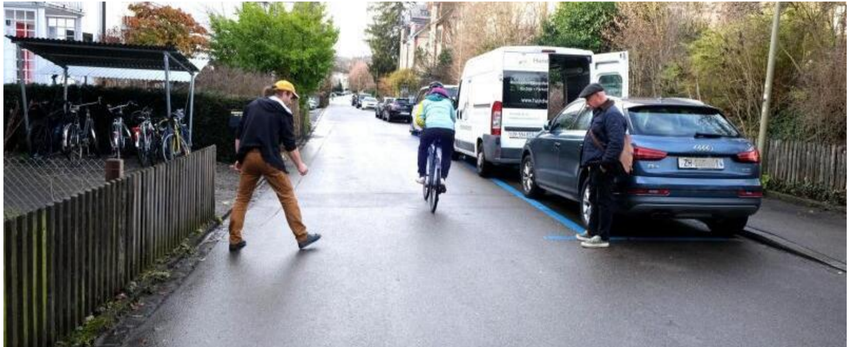
Jack Würigler (r.) und Michael Graf legen den Doppelmeter aus: Mit vier Metern reiner Fahrbahn wäre die Veloroute auch mit seitlichen Parkfeldern problemlos und ein genügender Sicherheitsabstand möglich, die Parkiersituation weiterhin Anwohnerfreundlich.
